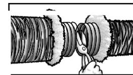
2. Jale la cubierta metálica y el aislamiento, dejando al descubierto el núcleo. Deslice al menos 1 pulg. (254 mm) de núcleo sobre el collar. Cubra el núcleo con al menos dos vueltas de cinta para ducto. También puede usarse una abrazadera.
