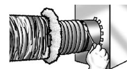
3. Vuelva a colocar el aislamiento y la cubierta metálica. Envuelva la cubierta con al menos dos vueltas de cinta para ducto. También puede usarse una abrazadera.
