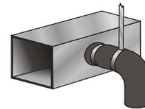
9. Los conductos instalados verticalmente tienen que ser estabilizados por cinchos a un máximo de seis pies entre soportes a través del centro.
