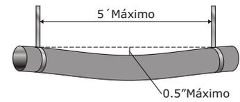
7. El material que soporta al tubo no debe ser menor a 1.5 pulg. (38mm) de ancho y no debe afectar el diámetro del ducto.
