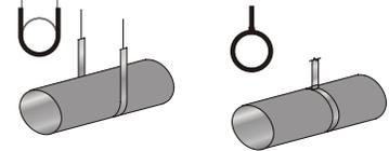
8. Soporte el ducto entre una conexión de metal y un doblez, permitiendo al ducto extenderse derecho unas cuantas pulgadas antes de hacer el doblez.
