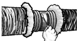
3. Vuelva a colocar el aislamiento y la cubierta metálica. Envuelva las cubiertas juntas, con al menos dos vueltas de cinta para ducto.
